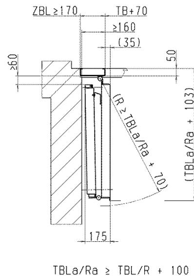
(Schematische Darstellung Türblattpaarung links (TBLa + TBL);
