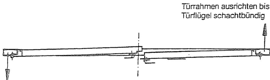
Als nächstes wird die Lage der Türblätter zur Schachtwand geprüft. Sind die Türblätter in der Türmitte nicht mit Schwelle oder Kämpfer bündig, so ist durch entsprechendes Verschieben des Türrahmens an den oberen bzw. unteren Ecken nachzurichten (siehe Abb. 3).
