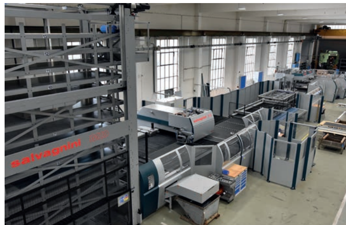
Salvagnini-Blecbearbeitungslinie bei Meiller installiert
