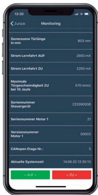
Monitoring und Statusinformationen zur Tür und dem MiDrive
